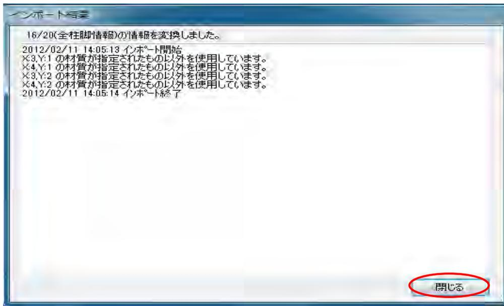
“閉じる” をクリックすると、柱リスト表の画面が表示され、各柱リストをダブルクリックすると「NC ベース P 柱脚検定」の解析結果が表示されます。
